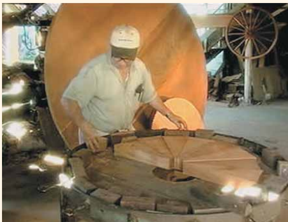
FIGURA 10. En el Taller Alfaro de Sarchí, don Fernando Alfaro muestra cómo se colocan las 16 cuñas para ponerles el aro de metal alrededor (arriba), el cual al calentarlo con carbón casi incandescente (derecha), se adhiere junto con las cuñas de madera. En la imagen inferior; se muestra cómo se le agrega agua tras lograr el calentamiento, lo que da lugar a la contracción de los materiales, quedando la rueda como si fuera una sola pieza sólida (última imagen). En este caso, el aro se le colocó a una rueda usada y decorada. Fotografías cortesía de Archivos Teletica Canal 7. 2004.
