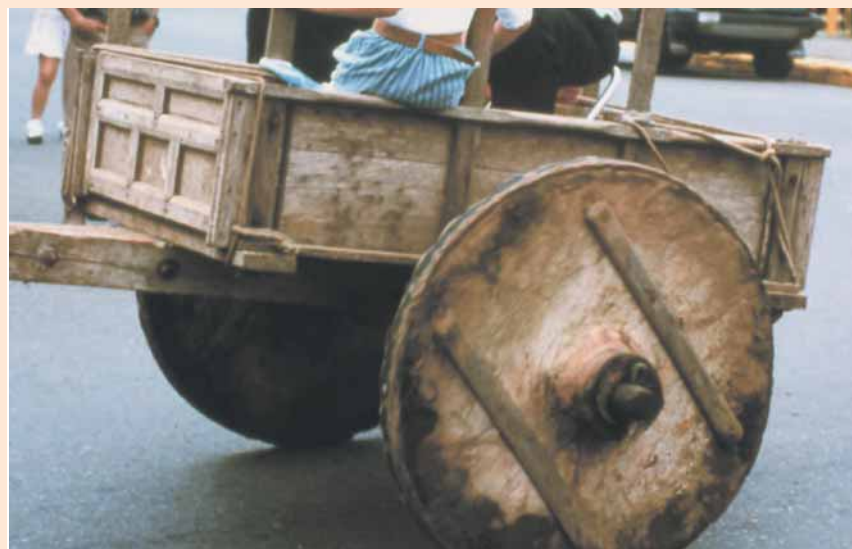
FIGURA 9. Izquierda: Rueda maciza. Nótese el desgaste en los bordes, donde remata el hilo de la madera. Abajo: Carreta con rueda maciza a la que le pegaron dos reglas como soporte. Fotografías: Lidilia Arias, 1998.
