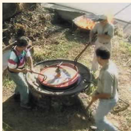
FIGURA 10. En el Taller Alfaro de Sarchí, don Fernando Alfaro muestra cómo se colocan las 16 cuñas para ponerles el aro de metal alrededor (arriba), el cual al calentarlo con carbón casi incandescente (derecha), se adhiere junto con las cuñas de madera. En la imagen inferior; se muestra cómo se le agrega agua tras lograr el calentamiento, lo que da lugar a la contracción de los materiales, quedando la rueda como si fuera una sola pieza sólida (última imagen). En este caso, el aro se le colocó a una rueda usada y decorada. Fotografías cortesía de Archivos Teletica Canal 7. 2004.
